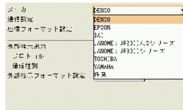
各メーカーのロボットと直接通信することが可能です。ロボットメーカーやロボット種類などを選択していただくの簡単操作で通信ができるため、PLCのプログラム工数の削減が可能になります。
