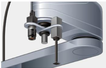
ロボットに取り付けたツールの座標を2点登録するだけで、自動計算によりツール座標系をロボット座標系に変換することができます。
