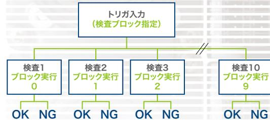
各ブロックの検査結果データは次回実行時まで保持されます。ブロックの実行タイミングを外部からコントロールすることで、専用アプリケーションを構築することが可能です。
