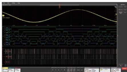
オシロスコープのチャンネル入力にTLP058ロジック・プローブを接続するだけでロジック8chに変更でき、最大64chの観測が可能です。
