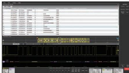
組込みや自動車などに採用されているさまざまなシリアル・バス規格の自動デコード、タイムスタンプ付きリスト表示が可能です。また特定の packets にトリガすることができ、デバッグ時間を大幅に短縮します。
