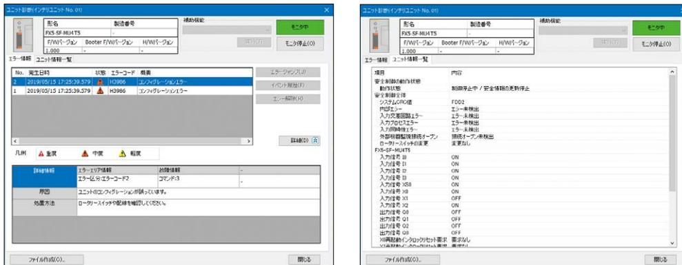
バッファメモリで安全機器の設定内容や入出力の状態を確認でき、安全制御の状態(装置の安全稼働時、非常停止時)で一般制御の動作を変更できます。安全増設ユニットでは、CPUから状態をモニタできるため、シーケンスプログラムで設定内容を確認し、対処方法を作業者に通知することもでき、復旧時間の短縮にも活用できます。
