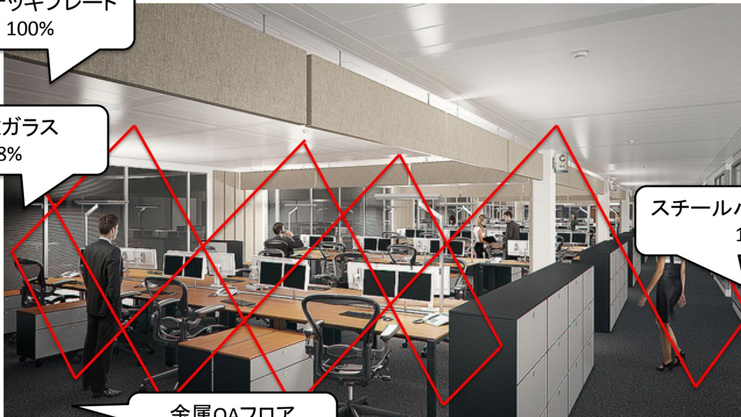
経路差のある電波が到来すると、受信電界強度の強弱が発生します。
